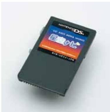
通常のカードより縦長な「DS方位センサーカード」を利用した星空ナビ。ちょうどシールの貼ってあるあたりの内部に地磁気と傾きを検出できるセンサーが内蔵されています。この部分はDS本体から飛び出した状態で使用します。
